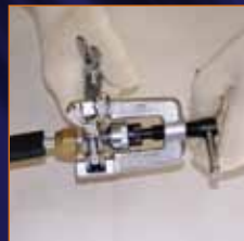
3. Bördeln des Rohres
